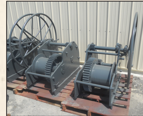
40 Ton Deck Winches
